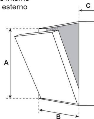
Foro Luce Sistema MW: misura sportello - 36 mm
